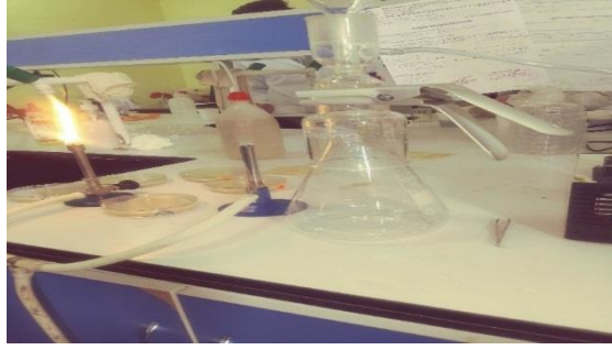
Figure III 6 : Dispositif de filtration sur membrane pour dénombrement des bactéries du filtre biologique labo de génie des procédés de Skikda.
