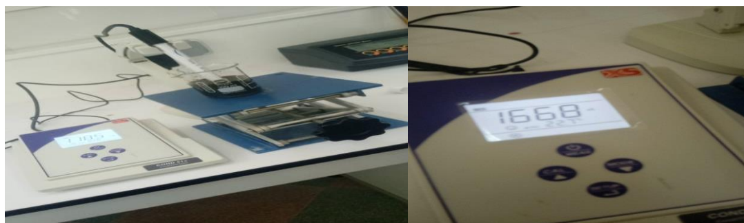
Figure 24 : mesure de conductivité
