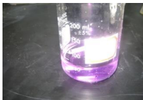
Figure 15: Changement de la couleur d'échantillon après titrage par l'EDTA.
