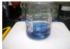
Figure 15: Changement de la couleur d'échantillon après titrage par l'EDTA.
