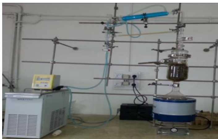
Annexe 1 : Montage d'extraction de l'huile essentielle d' H. cheirifolia par entrainement à la vapeur d'eau.
