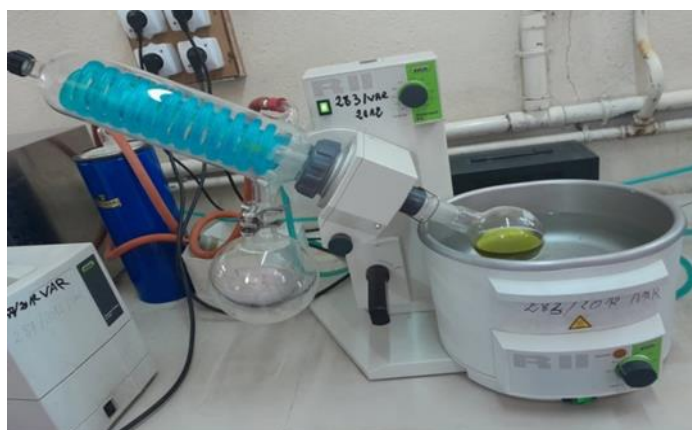
Annexe 3 : Montage d'évaporation des extraits organiques.
