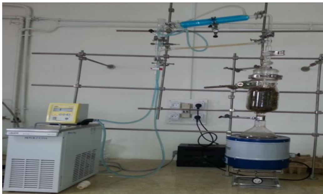
Figure II.2: Montage d'extraction de l'huile essentielle d' H. cheirifolia par entraînement à la vapeur d'eau.
