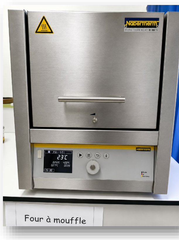
Figure III.11 : Four à moufle utilisé pour la calcination des catalyseurs Co/P-SiO 2 .
