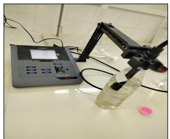
Photo n°18 : PH-mètre et Conductivité mètre (Mesure en laboratoire).
