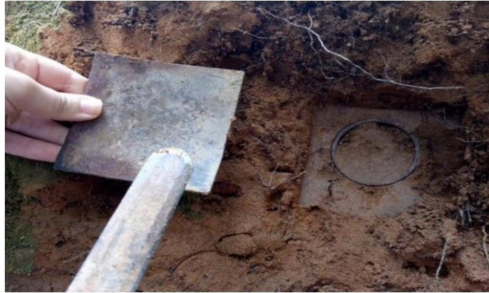
Figure 12. Détermination de la densité apparente par la méthode de cylindre
