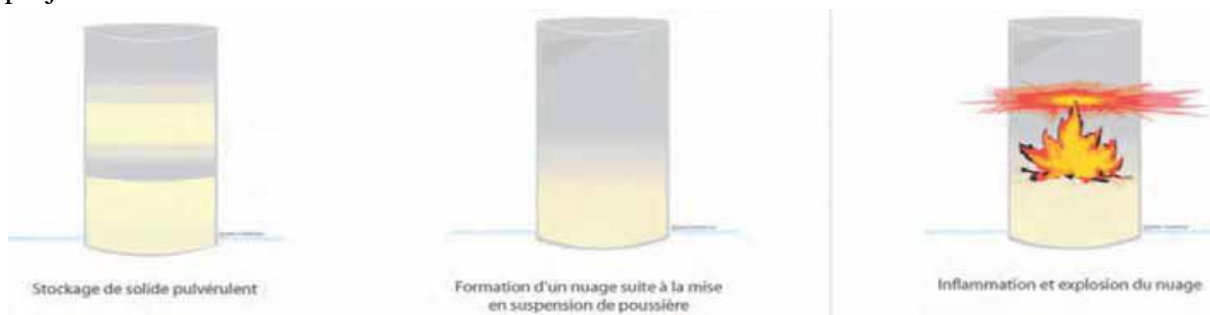
Figure 28: Schémas expliquant le phénomène de l'explosion de poussières
