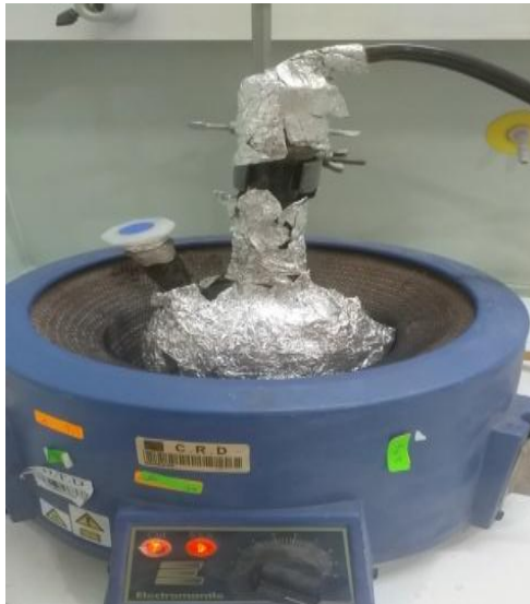
Figure VI.6 : Ballon bi-colles avec une chauffe ballon.
