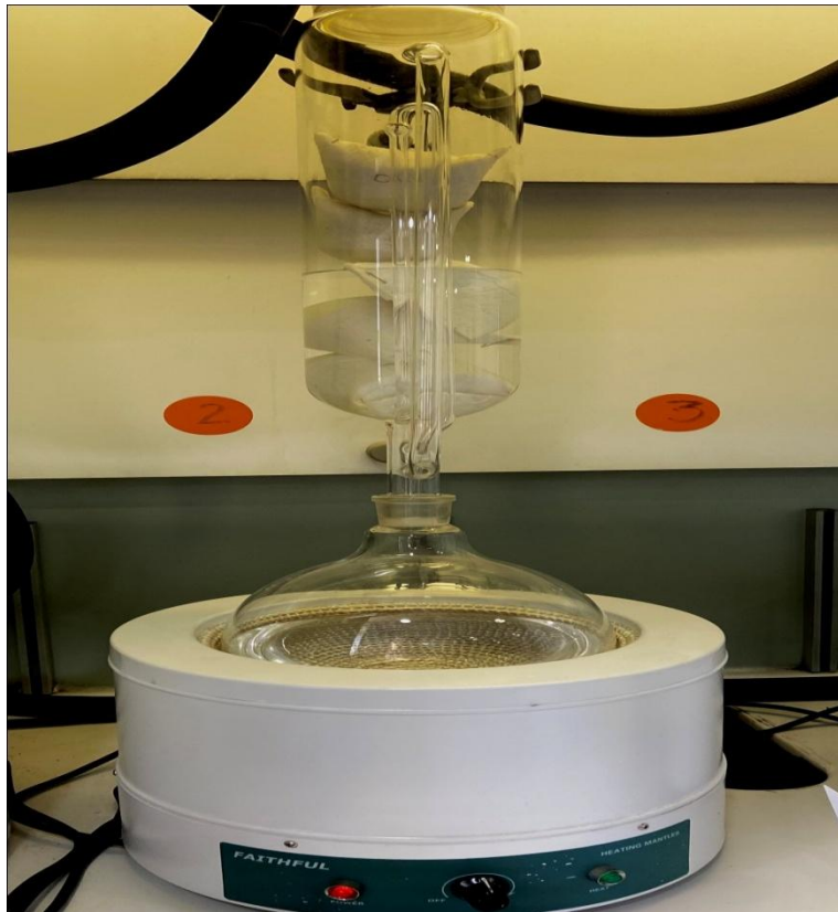
Figure VII.1 : Présentation d'appareil d'extraction par Soxhlet.
