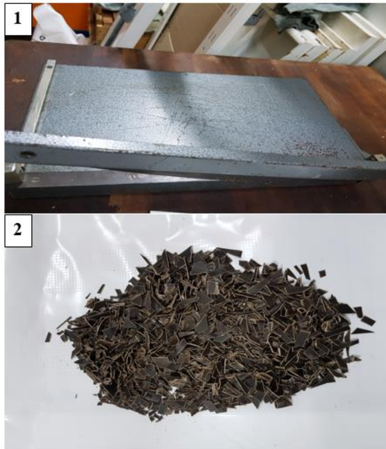
Figure II-5. (1) découpeuse manuelle (2) le produit résultant après avoir découpé les échantillons.
