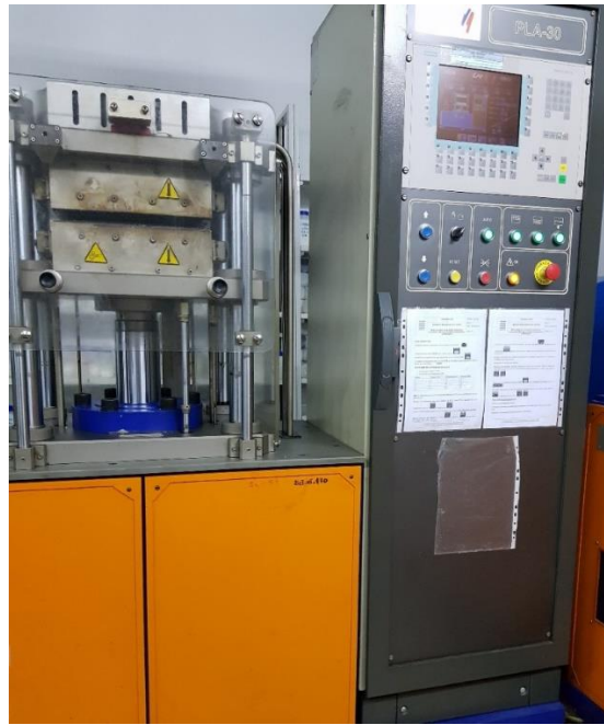
Figure II-6. La presse hydraulique (moulage par thermocompression).
