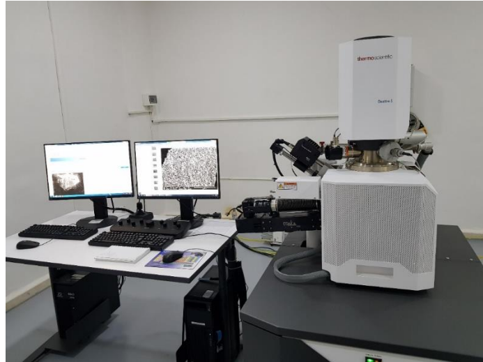
Figure II-14. Dispositif de microscopie électronique à balayage.
