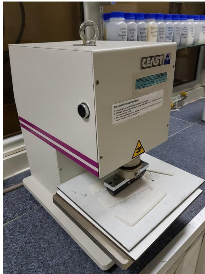
Figure II-7. La poinçonneuse pneumatique de découpage.
