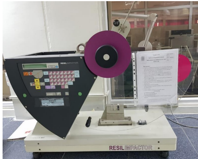
Figure II-9. Testeur d'impact IZOD.
