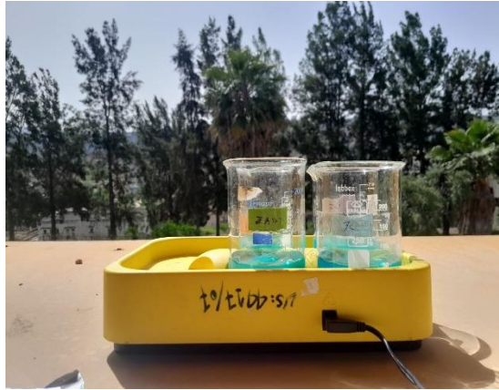
Figure II-8 : La photocatalyse des solutions contenant le bleu de méthylène appliqué sous irradiations solaire.
