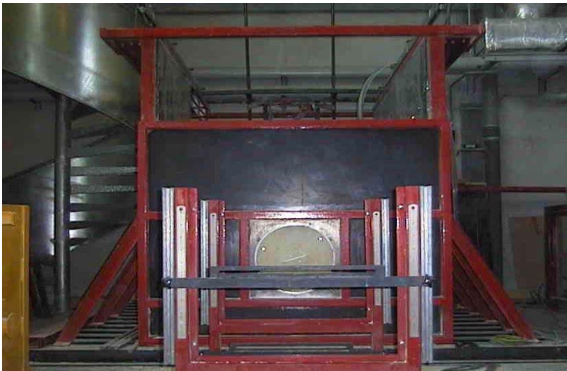
Figure 3.13 : Vue de face du modèle réduit de tunnel (E.N.T.P.E.)
