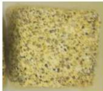
Figure III.12 : Eprouvette (5 X5 X 5) cm conservés dans H 2 SO 4 .
