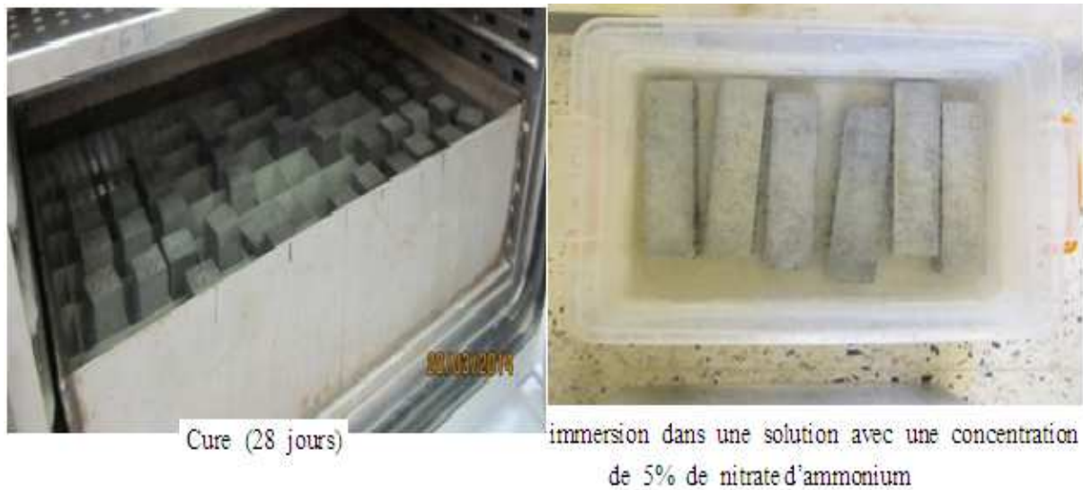
Figure IV.1 : Conservation des mortiers.
