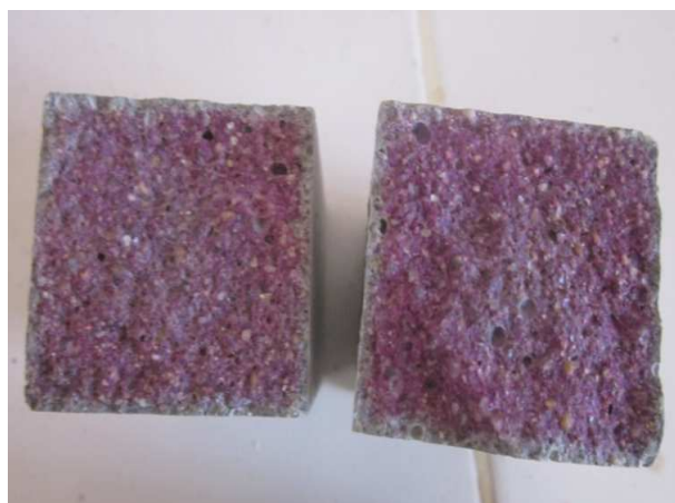
Figure IV.10: Profondeur de dégradation de mortier témoin après 90 jours d'immersion dans une solution 5% de nitrate d'ammonium.
