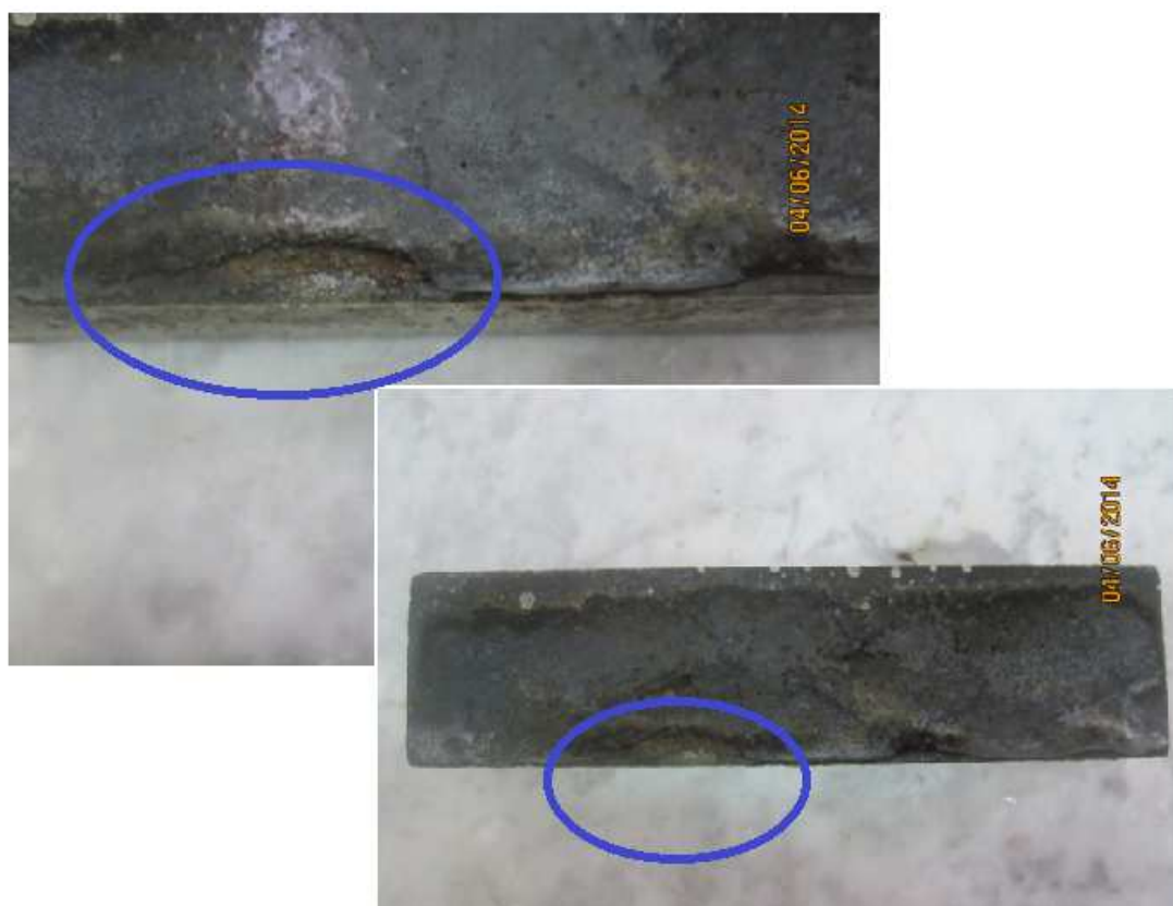
Figure IV.9 : Etat des éprouvettes de mortier après 180 jours de conservation dans une solution de 5% de nitrate d'ammonium.
