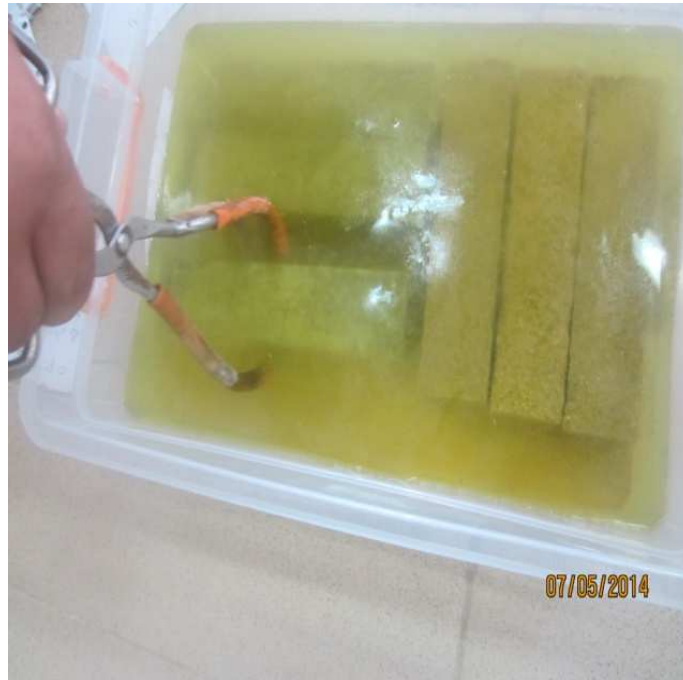
Figure III.1: Conservation des éprouvettes dans l'acide chlorhydrique
