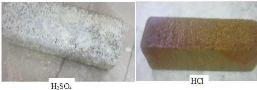
Figure III.7 Eprouvettes traitées par les acides H_2SO_4 et HCl
