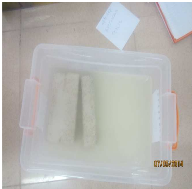
Figure III.2: Conservation des éprouvettes dans l'acide sulfurique
