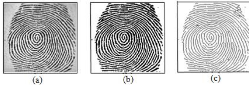
Figure 3.6. Résultats des étapes de binarisation et de squelettisation, (a) Empreinte originale, (b) Empreinte binarisée, (c) Empreinte squelettisée.
