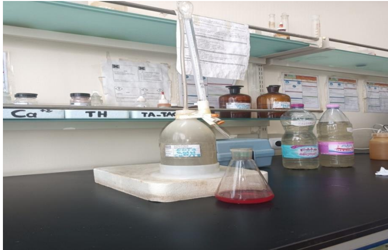
Figure II.12 : Mode opératoire de Calcium ( \text{Ca}^{+2} ) (Mme lawsif R, et Mr Sebbagh M. .2023)
