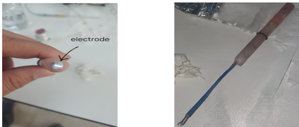
Figure II.8 : electrode du métal A-106 B
