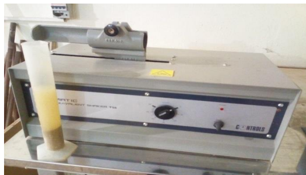
Figure II.6. Machine d'équivalent de sable.
