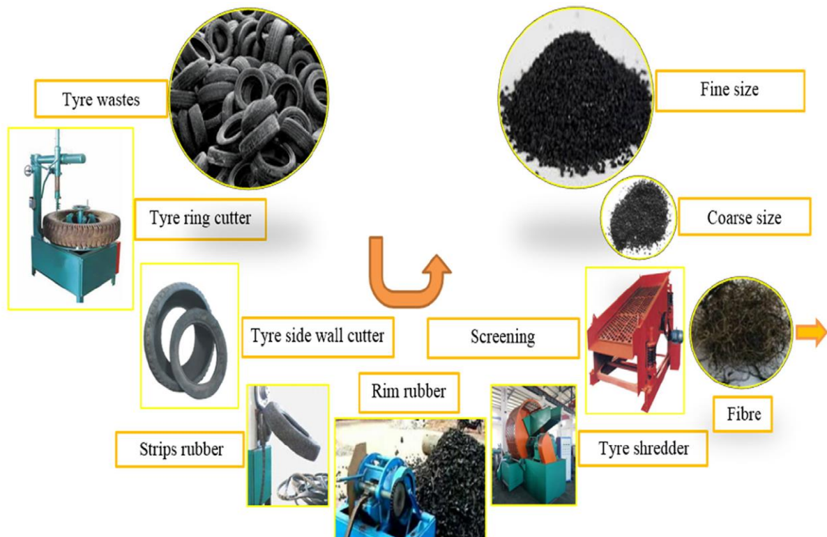
Figure I.6. Différentes étapes de déchetage des pneus [17].
