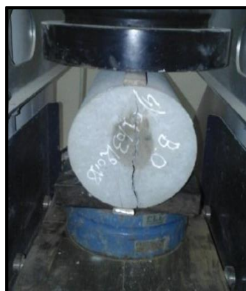
Figure II.17. Réalisation essai traction par fendage.
