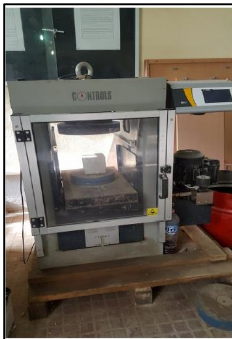
Figure II.15. Presse utilisée pour l'essai de compression.
