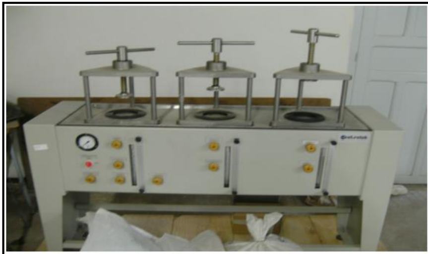
Figure II.22. Photo du perméabilimètre à l'eau utilisé.
