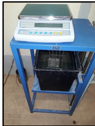
Figure II.13. Dispositif d'essai par pesée hydrostatique.
