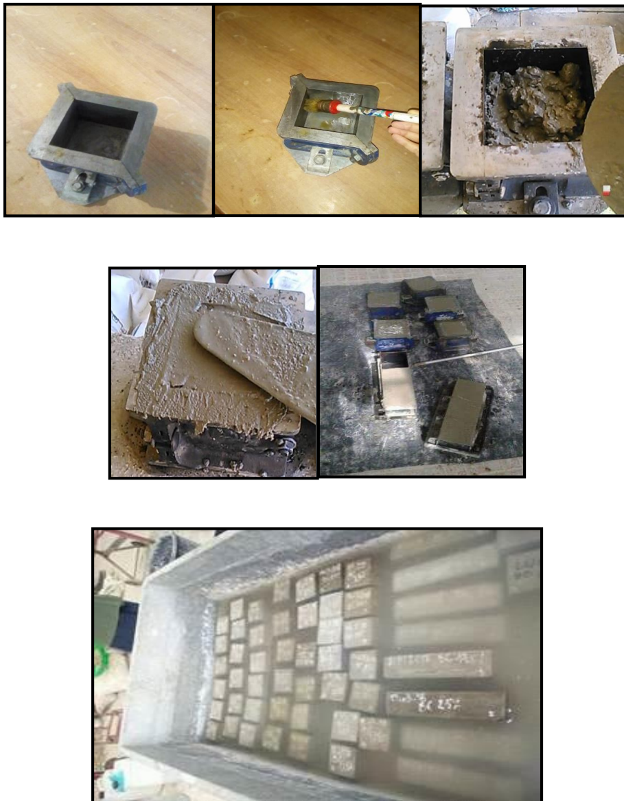
Figure II.9. Mise en place du béton et la conservation des éprouvettes.
