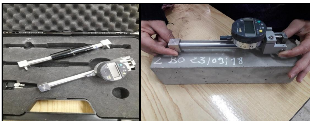
Figure II.14. Mesure de retrait à l'aide d'un rétractomètre digital.
