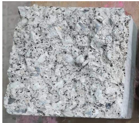
Figure III.2. Distribution des particules de caoutchouc dans une éprouvette BC25% écrasée par fendage.
