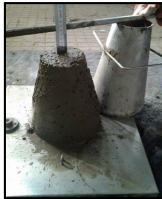
Figure II.10. Mesure de l'affaissement au cône d'Abrams.
