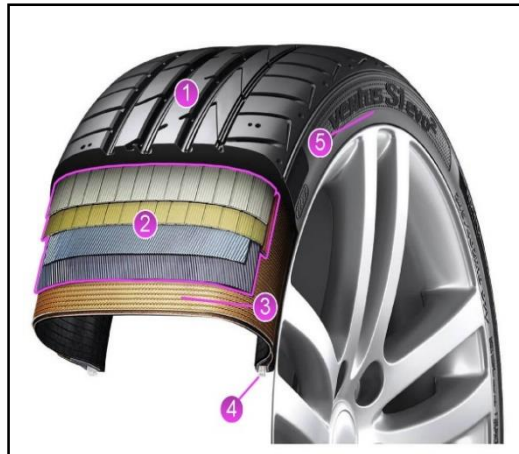
Figure I.5. constituants d'un pneu [14].
