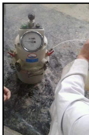
Figure II.12. Essai teneur en air occlus.
