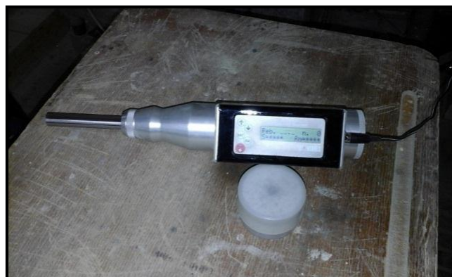
Figure II.20. Photo du scléromètre utilisé.
