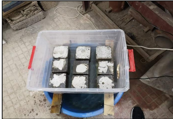
Figure III.20. Essai d'absorption d'eau par capillarité.
