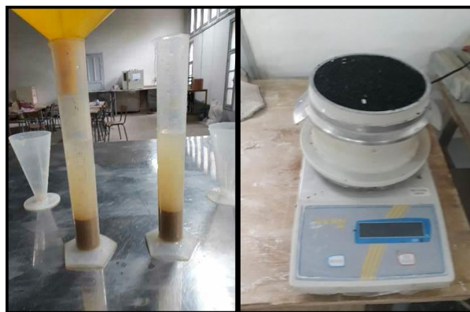
Figure II.5. Mesure des masses volumiques absolue et apparente.
