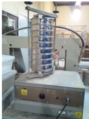
Figure II.2. Tamiseuse utilisée pour l'essai d'analyse granulométrique.
