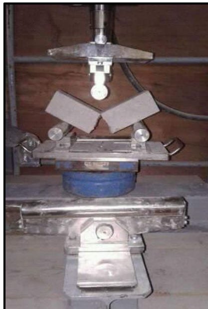
Figure II.18. Essai de traction par flexion.
