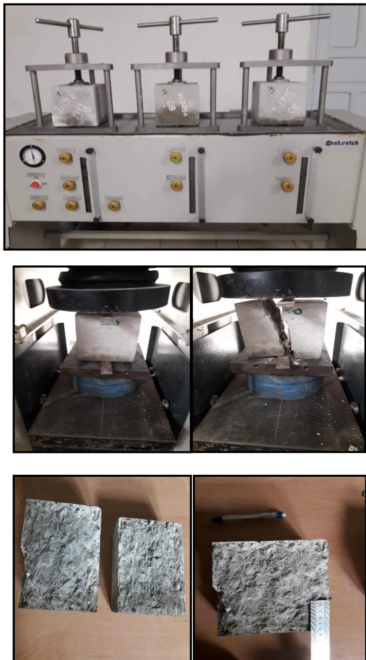
Figure III.23. Etapes de mesure de la perméabilité à l'eau.
