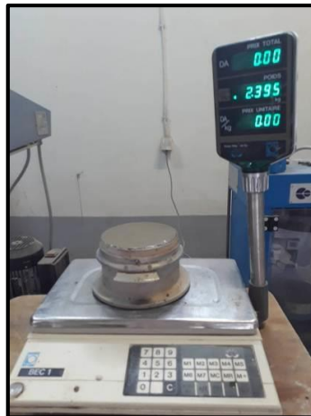
Figure II.11. Essai masse volumique du béton frais.
