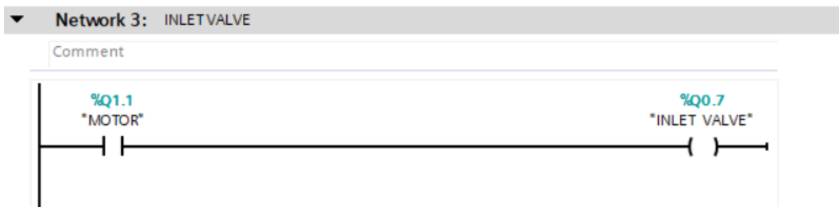
Figure IV-19: commande de la vanne d'entrée
