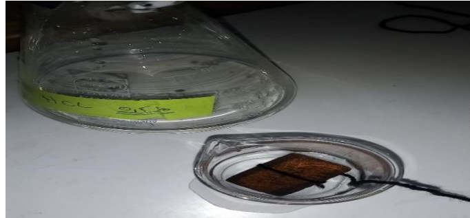
Figure III.30: Échantillon immergé dans une solution de HCl à 0,5 % pendant 30 secondes
