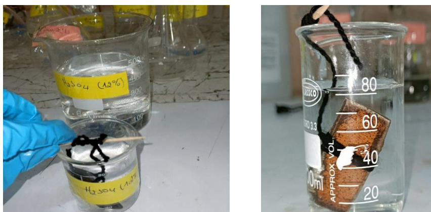
Figure III.25: immersion de l'échantillon dans solution aqueuse de H_2SO_4 à 12%
