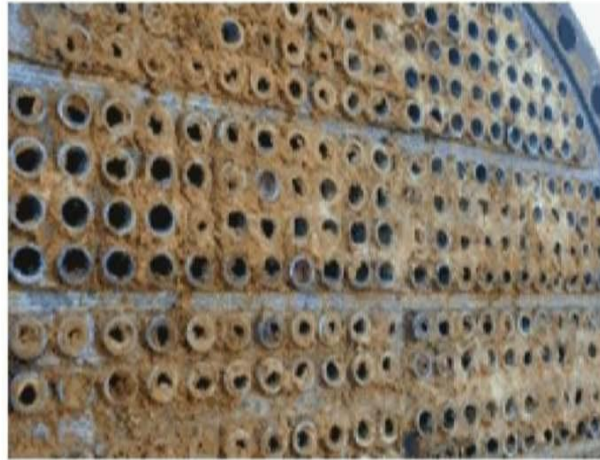
Figure II.10: L'encrassement dans un échangeur tubulaire [5].
