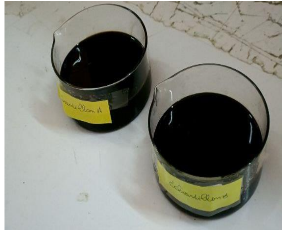
Figure III. 7: immersion de les échantillons A et B dans 10W40
