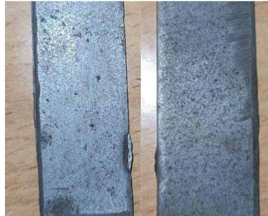
Figure III.27: échantillon après traitement à l'acide sulfurique (12%)
