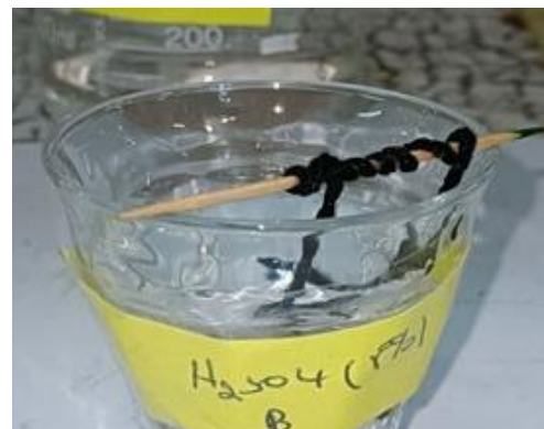
Figure III.15: immersion de l'échantillon B dans une solution aqueuse de (5%) H_2SO_4
