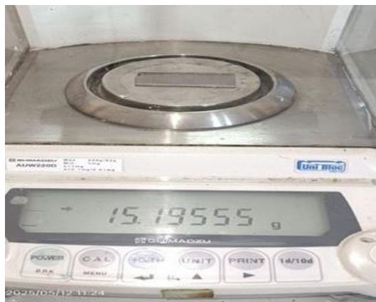
Figure III.27: échantillon après traitement à l'acide sulfurique (12%)
