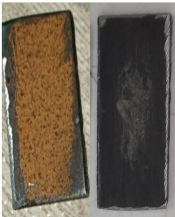
Figure III.31 : Échantillon avant traitement par Noah et HCl
