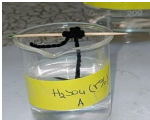
Figure III.14: immersion de l'échantillon A dans une solution aqueuse de (5%) H_2SO_4
