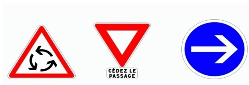
Figure 53:panneaux de signalisation d'un carrefour giratoire
