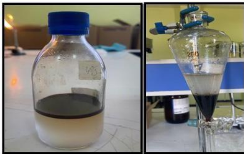
Figure IV.17: Dispositif expérimental pour l'étude de la biodégradation des hydrocarbures et préparation des extraits pour analyse GC-MS.
