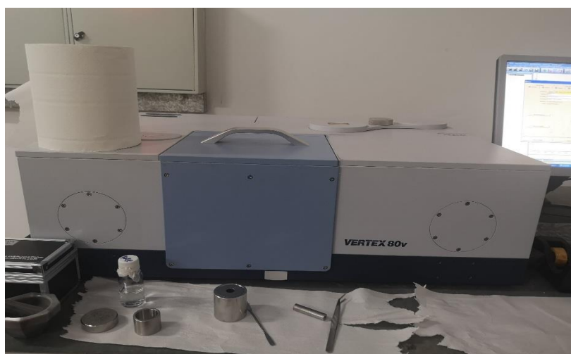
Figure III.4. Spectromètre infrarouge à transformée de Fourier (IRTF) (Vertex 80v, Bruker)
