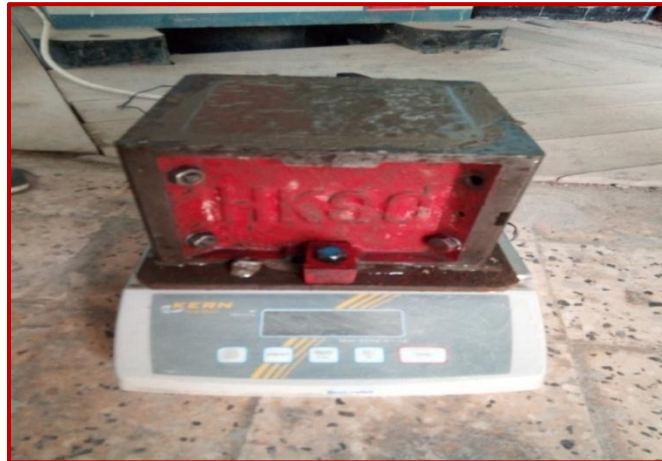
Figure III-7: Mesure de la masse volumique du béton frais
