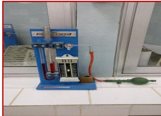
Figure II-3: Mesure de la surface spécifique de Blaine
