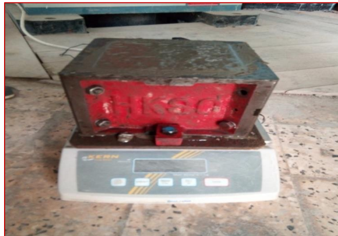
Figure I-3: Mesure de la densité (prise de vue)
