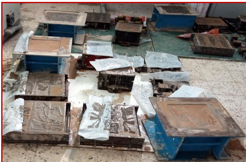
Figure III-3: Eprouvettes avant le démoulage
