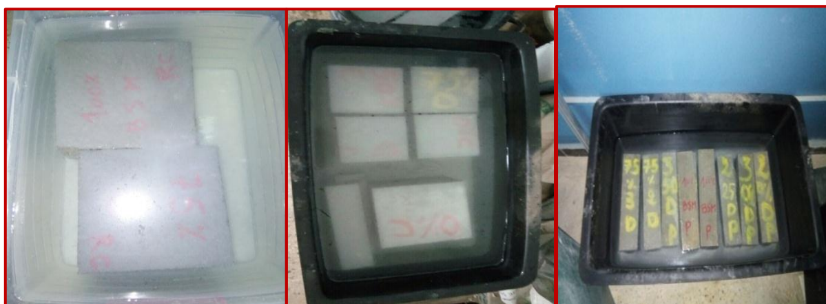
Figure III-4: Conservation des éprouvettes dans l'eau
