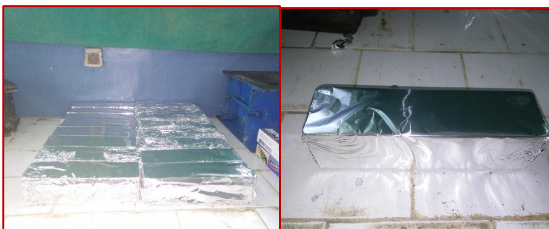
Figure III-5: Eprouvettes enveloppées de papier aluminium
