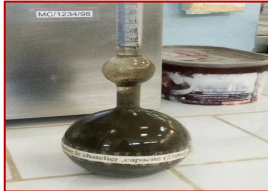
Figure II-2: Mesure de la densité
