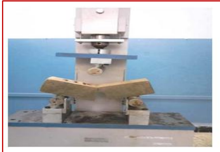
Figure III-11: Essai de traction par flexion trois points
