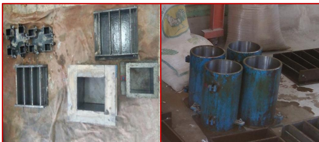
Figure III-2: Différents types des moules utilisés
