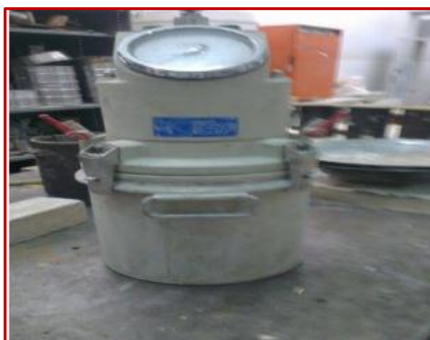
Figure III-9: Aéromètre à béton
