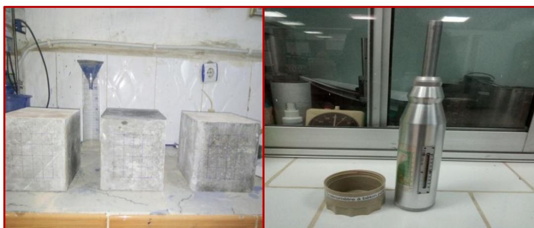
Figure III-13: Essai au scléromètre
