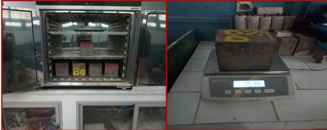
Figure III-14: Essai d'absorption par immersion
