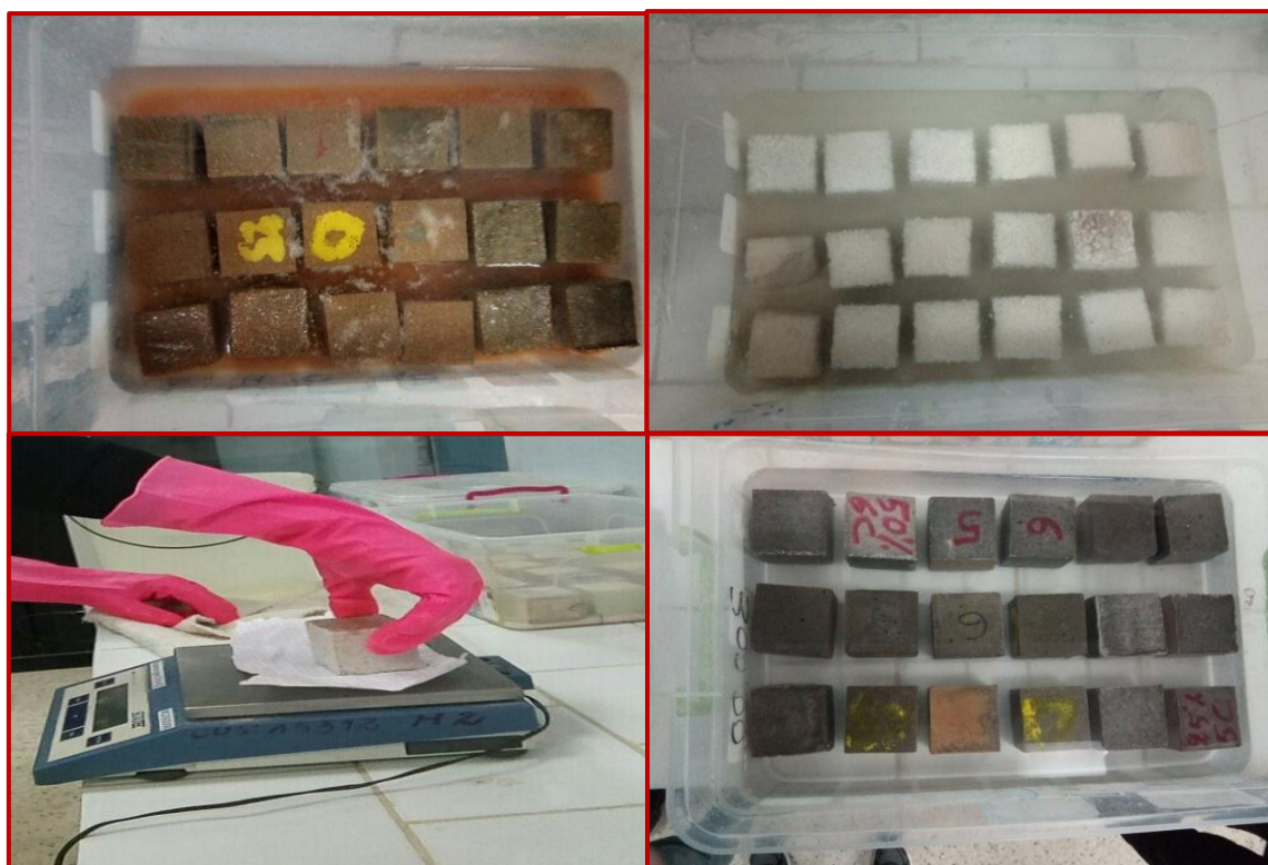
Figure III-18: Essai des attaques chimiques
