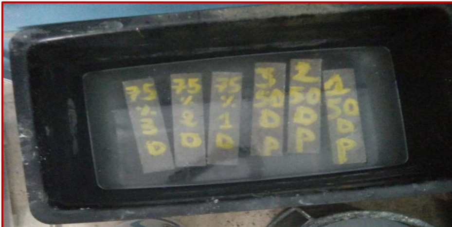
Figure III-19: Conservation des éprouvettes dans la solution des chlorures de sodium NaCl
