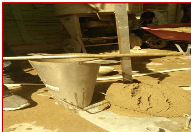
Figure III-8: Affaissement au cône d'Abrams
