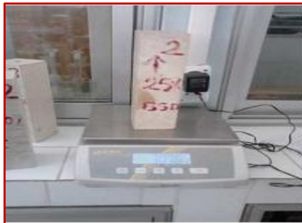
Figure III-15: Essai perte en masse
