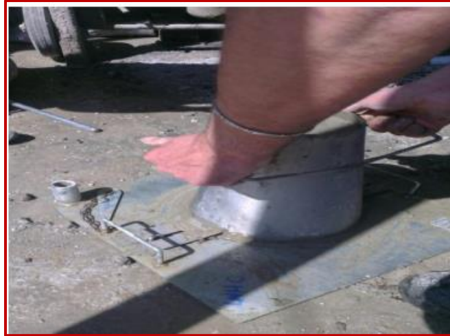
Figure I-1: Affaissement au cône d'Abrams(prise de vue)
