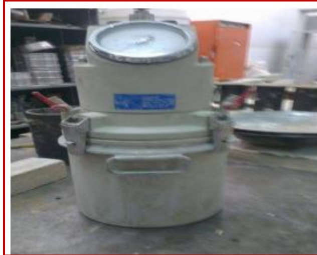
Figure I-2: Aéromètre à béton (prise de vue)
