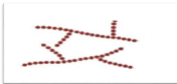
Figure I.4: Polymère à molécule ramifiée [4].
