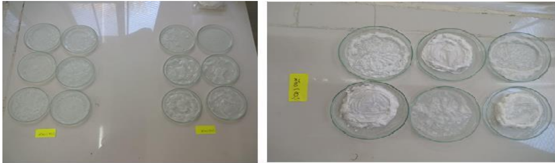
Figure III.7: Films en polyamide 12 renforcés par oxyde de zinc (PA12/ZnO) à différentes concentrations (1.5%; 3%; 5%; 10%; 15%; 20%).
