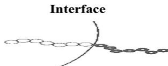
Figure I.20: Représentation schématique de copolymères à l'interface d'un mélange polymérique hétérogène [44].
