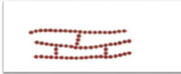
Figure I.5: Polymère à molécule réticulée [4].
