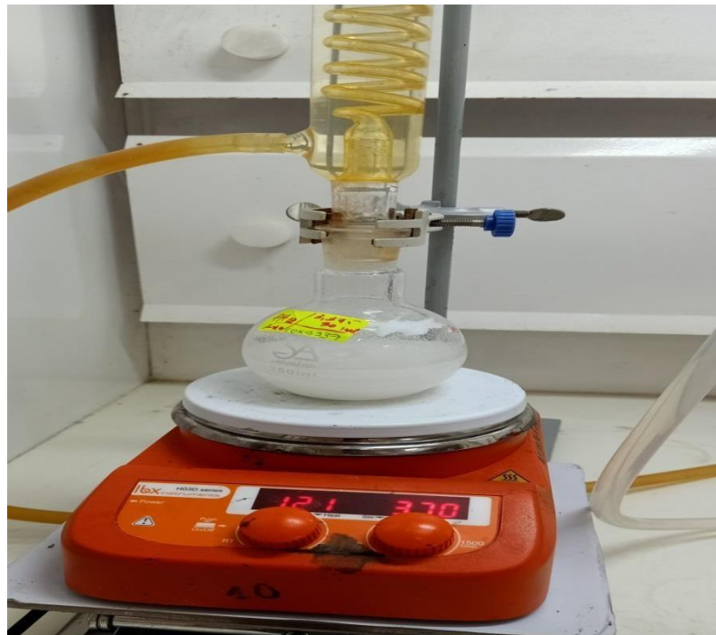
Figure III.5: Montage de la synthèse des films en PA12.
