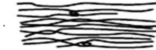
Figure I.8: Réseau d'un polymère cristallin [15].
