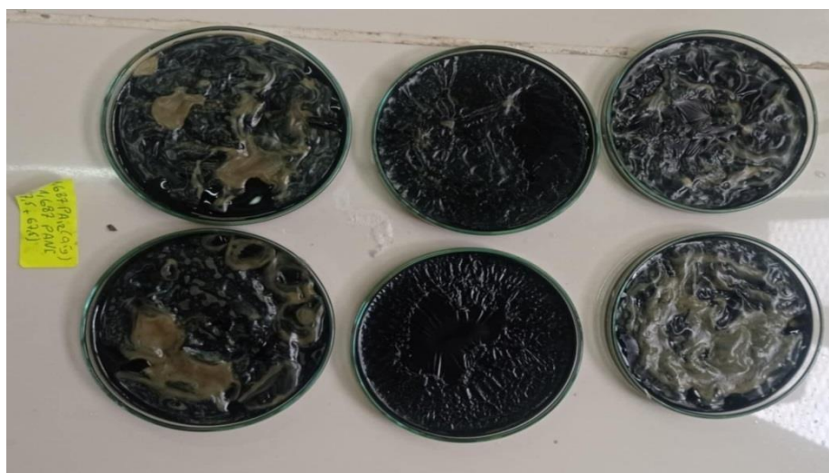
Figure III.8: Films en polyamide 12 renforcés par la polyaniline (PA12/PANI) à différentes concentrations (0.5% et 1%).
