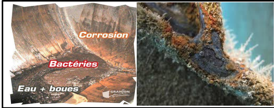
Figure I.2. La corrosion bactérienne.
