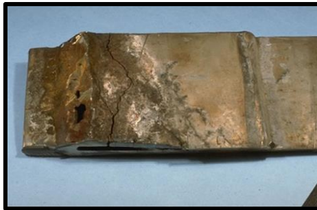
Figure I.11. La corrosion sous contrainte.
