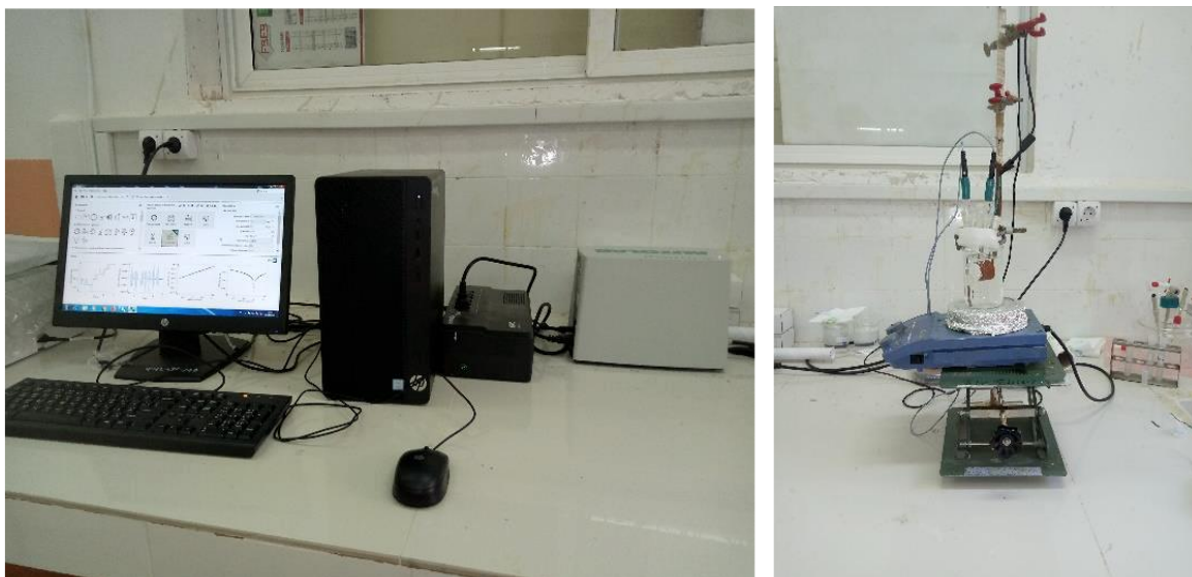
Fig. III.15. Montage pour les essais électrochimiques : (gauche) Potentiostat AUTOLAB PGSTAT 302 N et logiciel, (droite) cellule électrochimique en configuration expérimentale.
