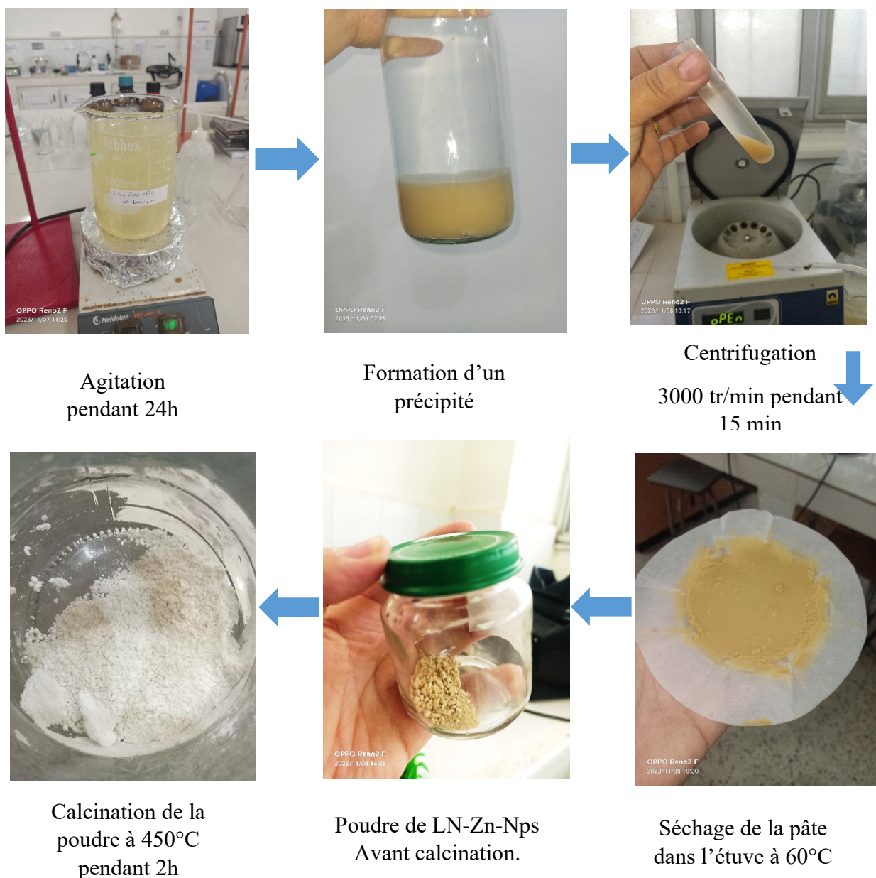
Fig. III.4. Protocole de biosynthèse des nanoparticules de zinc par extrait de Laurus Nobilis .
