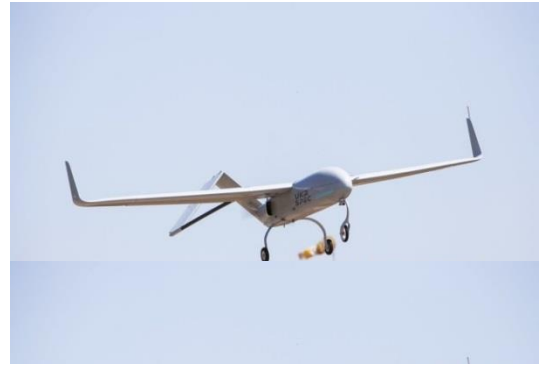
PD-1 : d'une envergure de 4m, 8kg de charge utile et un temps de vol de + 10h.
