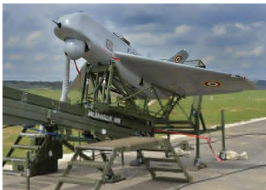
Sperwer (SDTI) : d'une longueur de 3.5m, envergure de 4.2m, endurance max de 6h et vitesse max de 240km/h.
