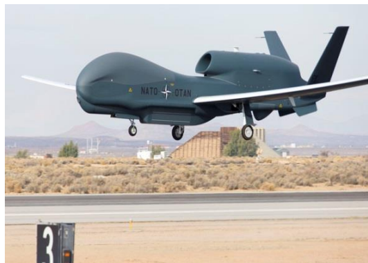
RQ-4B Global Hawk : d'une longueur de 14.5m, envergure de 39.8m, endurance max de 36h et vitesse max de 635km/h.
