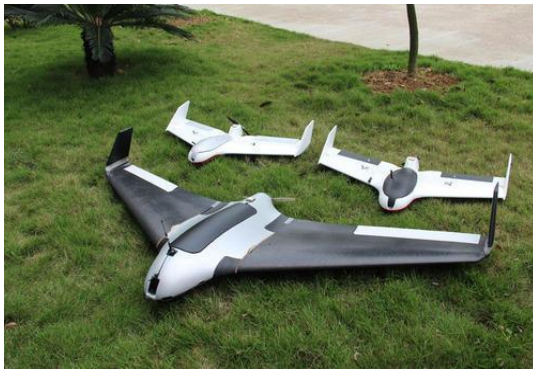
TECHNO UAV : d'une envergure de 2 m, une batterie de 5300 m.A.h et un temps de vol peut atteindre 60 min.
