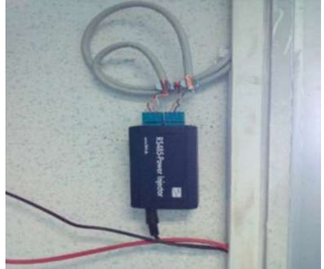
Figure A.11 : Montage du RS485-Power Injector
