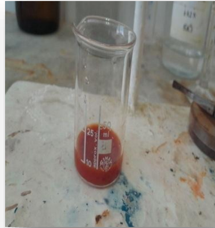
Figure 12 : Coloration de \text{Cl}^- avant le titrage (photo originale).
