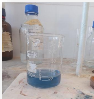
Figure 09 : Dureté totale à la fin de titrage (photo originale).
