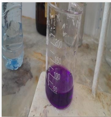
Figure 08 : Dureté totale avant le titrage (photo originale).
