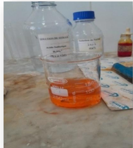
Figure 07 : Photo de titrages (\text{HCO}_3^-) . (La coloration devient orange) (photo originale).
