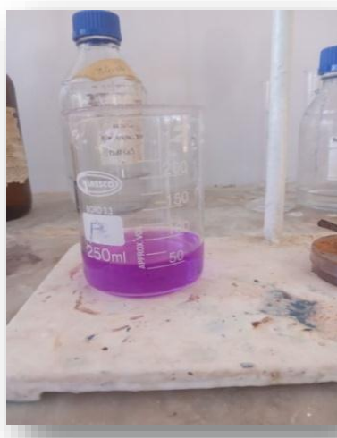
Figure 11 : Coloration de ( \text{Ca}^{2+} ) après le titrage (photo originale).
