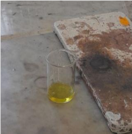
Figure 13 : Coloration de \text{Cl}^- à la fin de titrage (photo originale).
