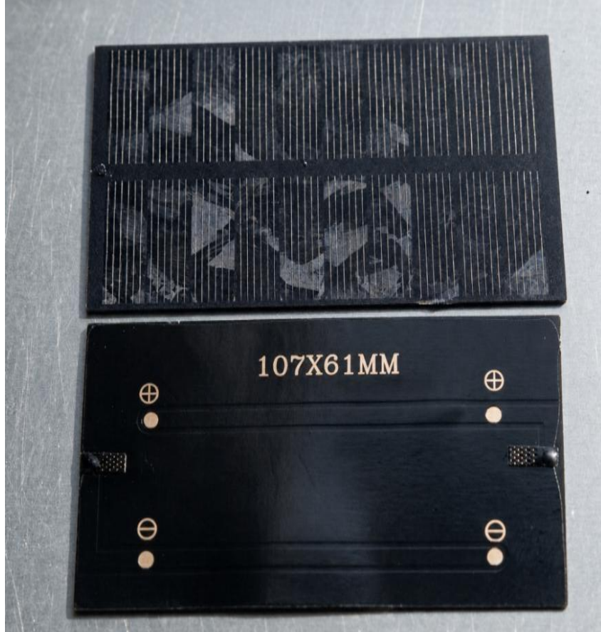
الشكل 6.III: اللوح السيليكوني احادي البلورة المستعمل
