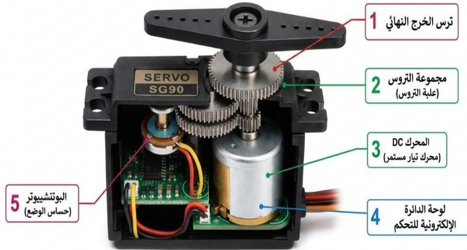
الشكل 5.III: البنية الداخلية للمحرك سيرفو
