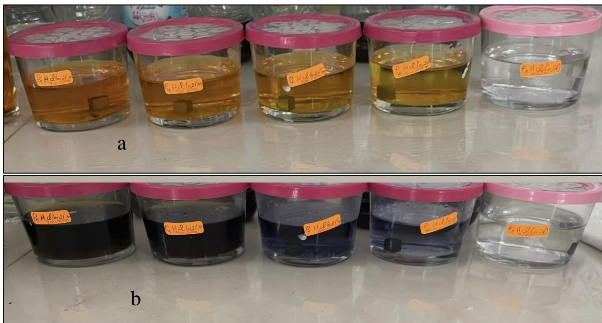
Figure III.11: a) Echantillons immergés en milieu \text{HCl}(0,25 \text{ M}) + \text{inhibiteur} avant 96h, b) Echantillon après 96h de l'immersion.
