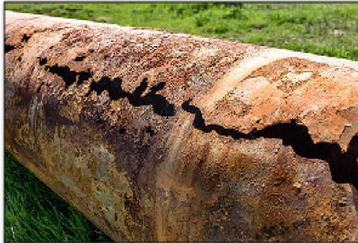
Figure I.8: La corrosion-érosion d'un tuyau [26].
