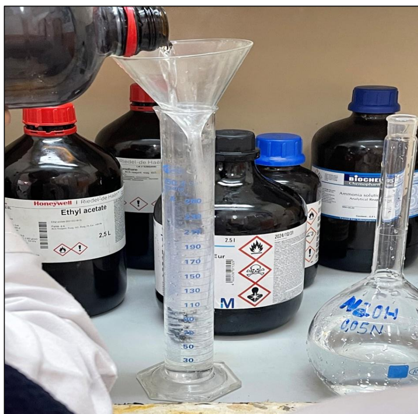
Figure III.7: Préparation de la solution corrosive HCl.
