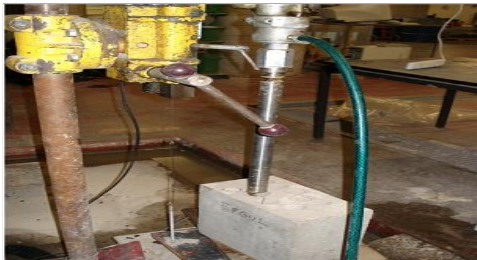
Figure III. 4 : Photo de l'installation de laboratoire pour les expériences de forage
