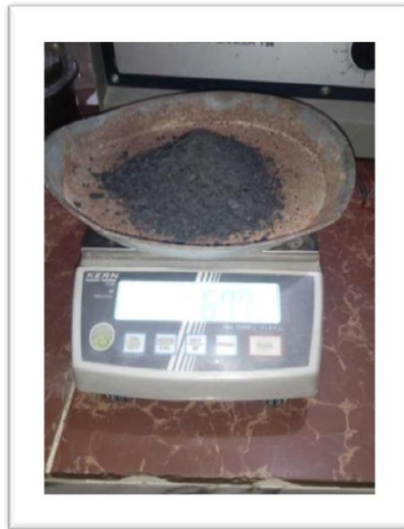
Figure 1.3 La mesure de la masse des cendres
