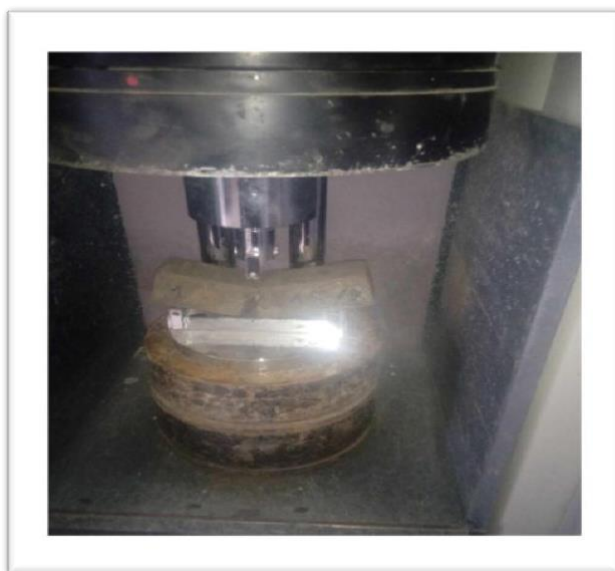
Figure 3.9 essai de traction par flexion
