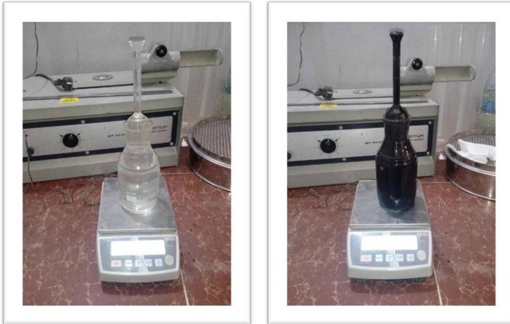
Figure 2.4 La mesure de la masse volumique absolue
