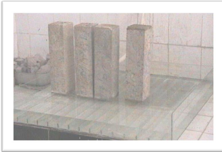
Figure 3.11 absorption d'eau par capillarité
