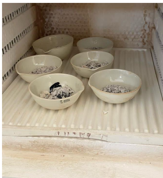
Figure 24: Procédé de combustion
