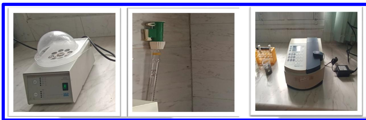
Figure IV.18. : L'équipement de la DCO (Micropipette Spectrophotomètre et Thermostat)
