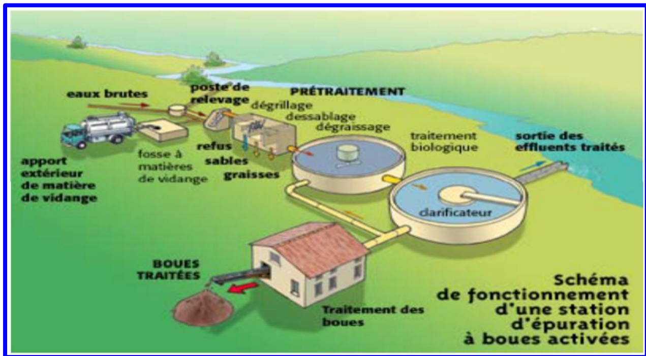
Figure II.3. Schéma de fonctionnement d'une station d'épuration
