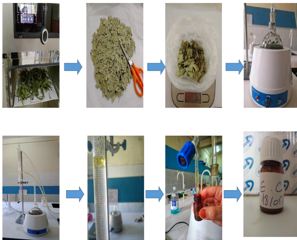
fig. 13 : Les étapes de la production de l'HES.
