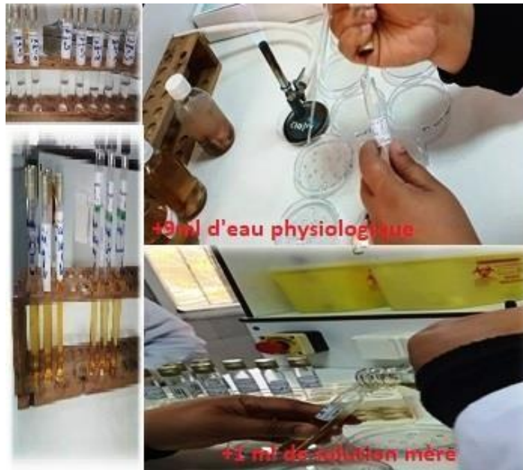
Figure12 :Etapes de la préparation des dilutions décimales (Photos personnelles, 2023).
