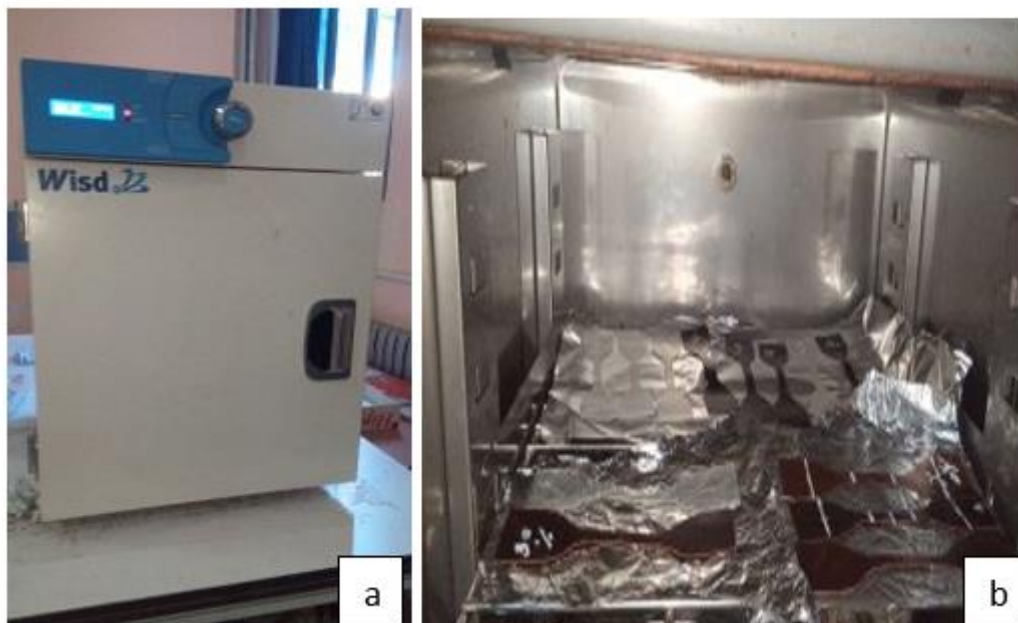
Figure III.13 : (a)étuve, (b) des éprouvettes dans l'étuve.
