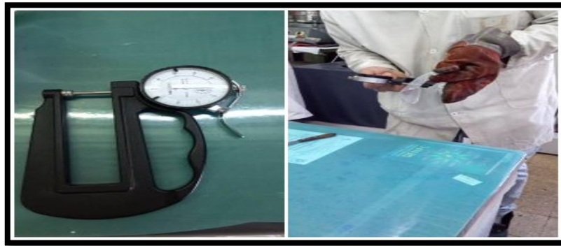
Figure III.7 : Mesure de l'épaisseur des films.
