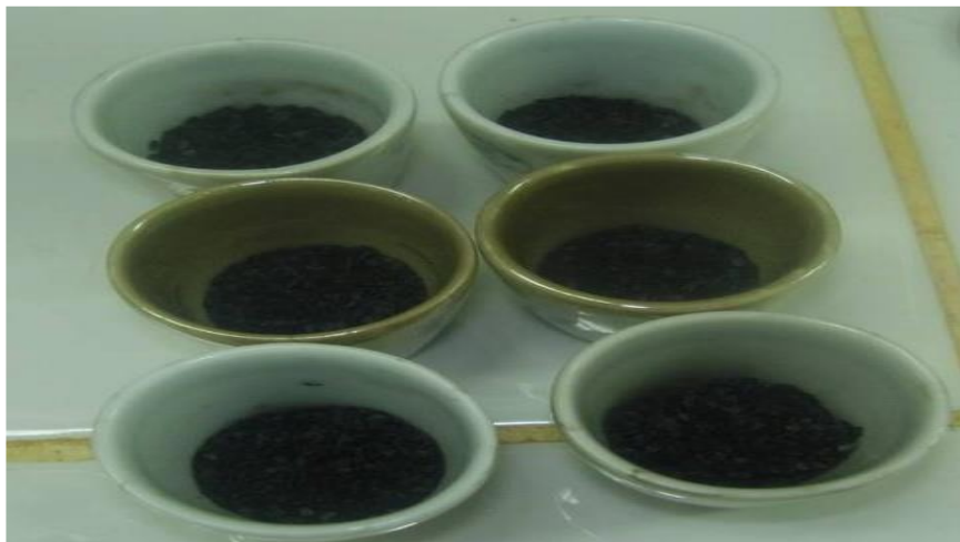
Figure I.19: Charbon actif synthétisé à partir des noyaux de dattes [63].
