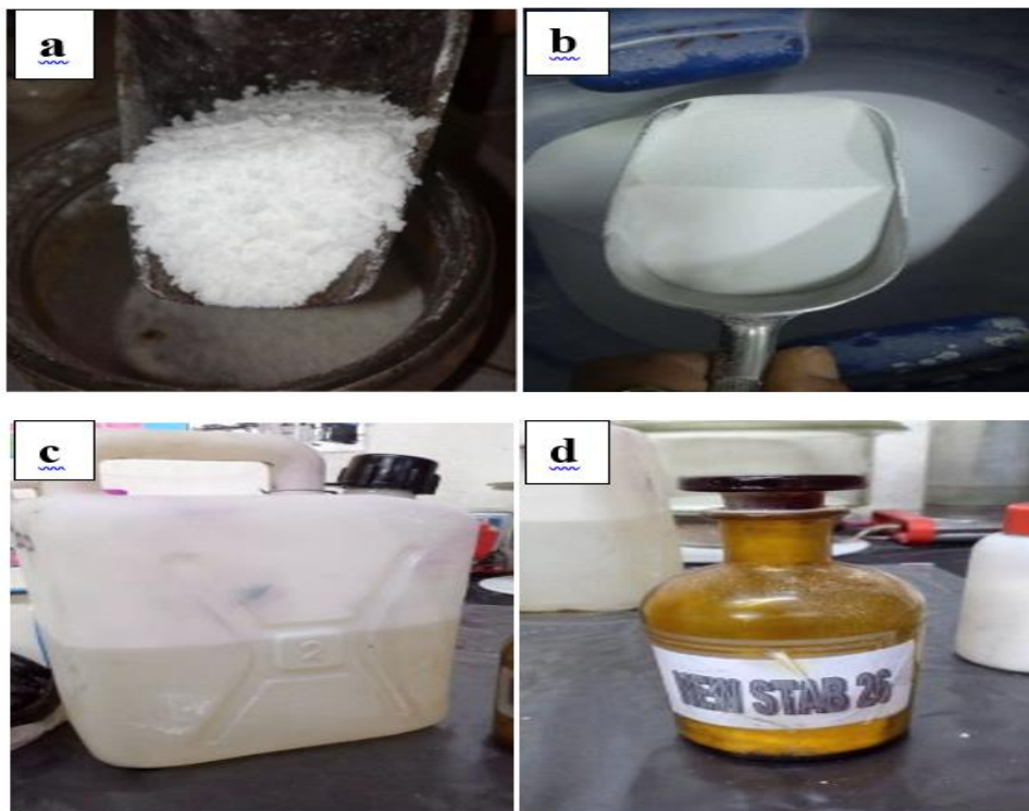
Figure III.2 : (a) Acide st arique, (b) PVC, (c) Stabilisant Ca/Zn, (d) plastifiant(DOP).
