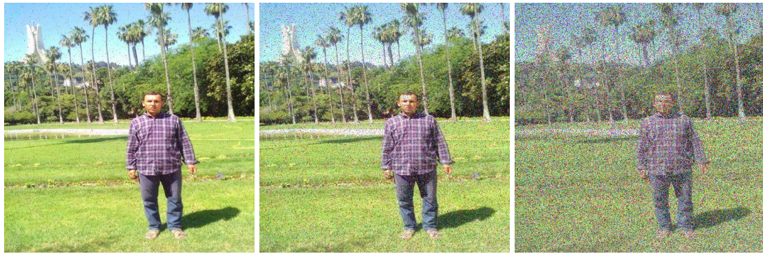
Fig. 3.11 Images déchiffrées avec bruit de sel et de poivre
