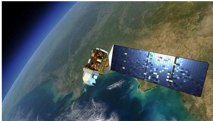
Figure II.2: Le satellite Landsat 8/9 équipé de l'instrument OLI [45].
