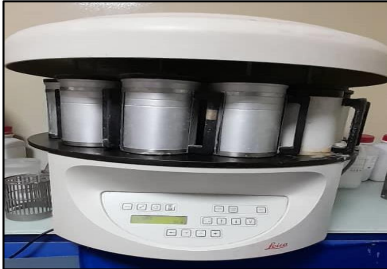
Figure 14 Déshydratation des prélèvements dans l'appareil automatisé (Photo original)
