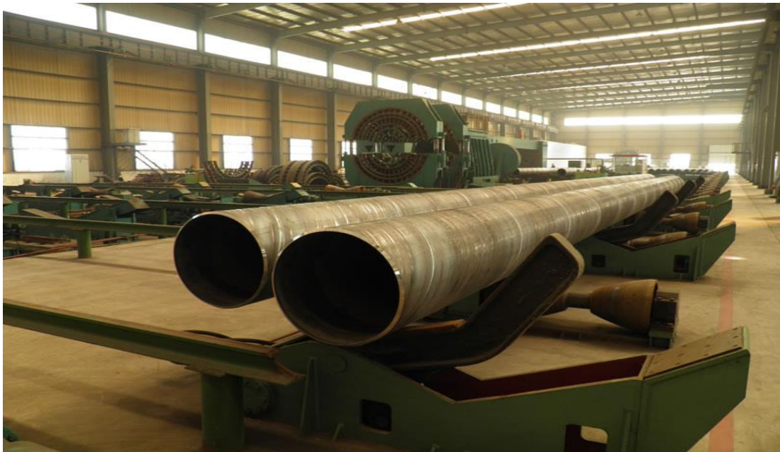
Figure.I.1 : Les tubes soudés sous forme spirale [7].
