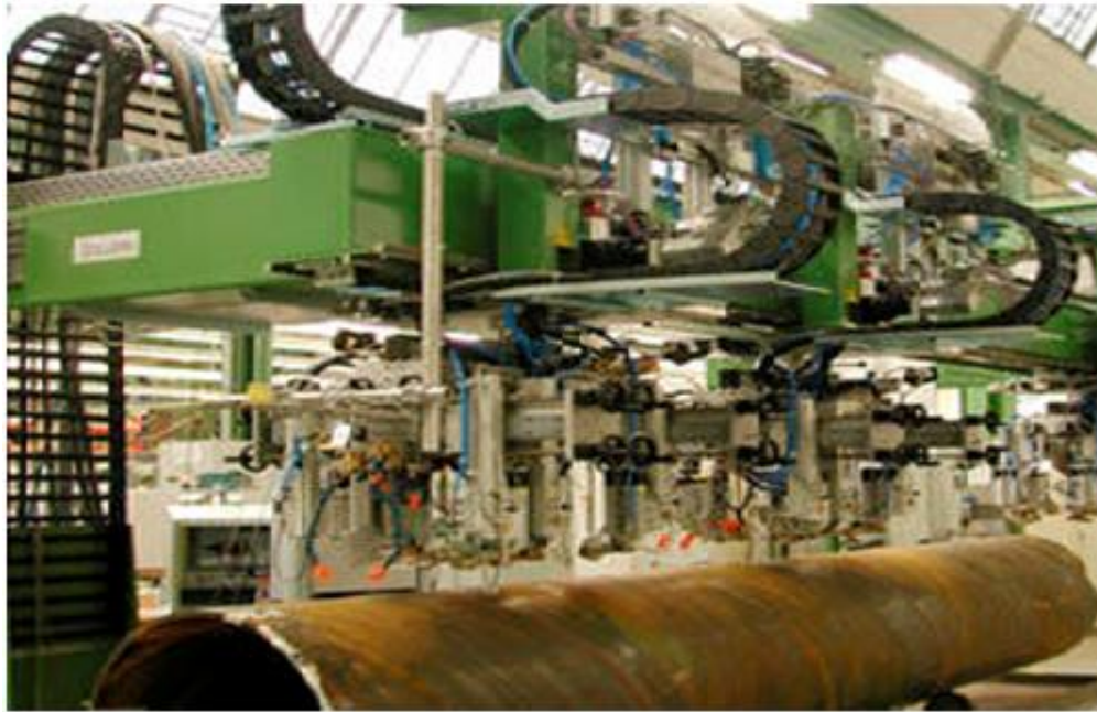
Figure.I.6 : Machine de contrôle ultrason automatique [12].
