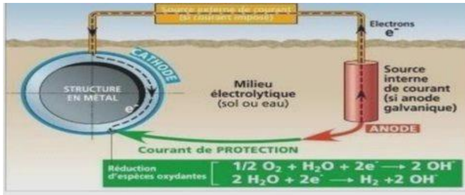
Fig. II.9. Principe de la protection cathodique [55].
