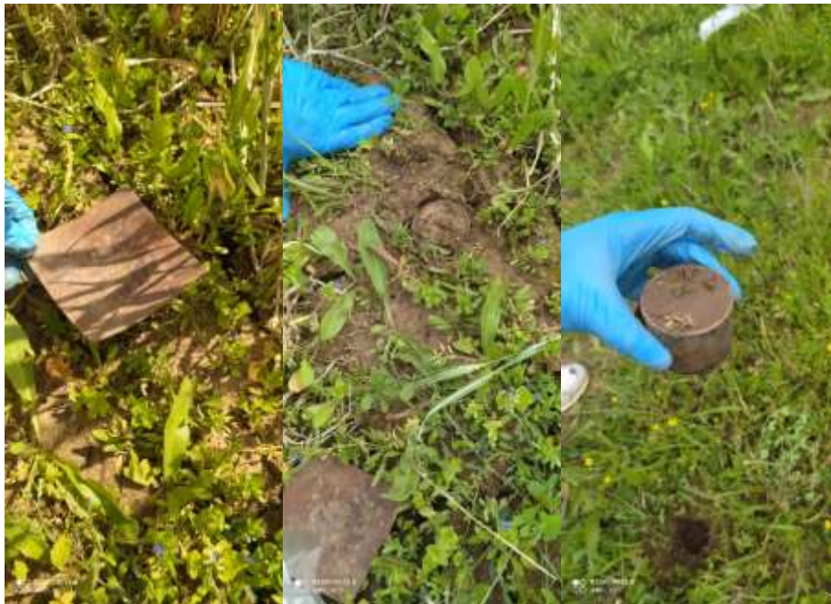
Figure (5) : Détermination de la densité apparente par la méthode de cylindre.
