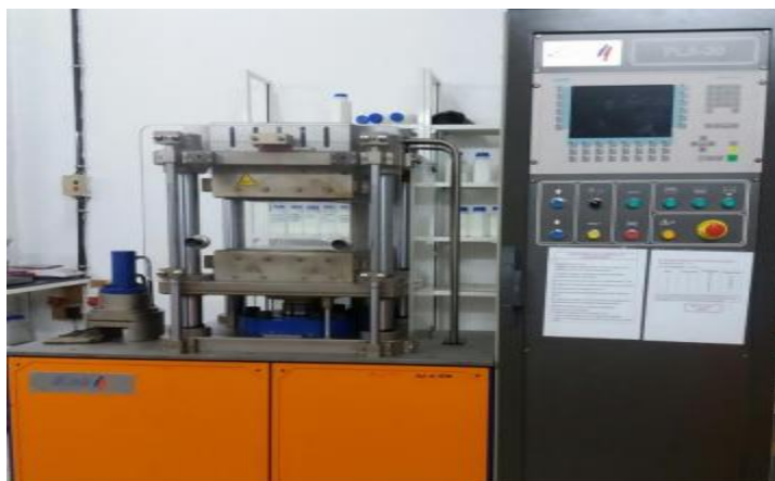
Figure IV.10 : Photo représentatif d'une presse hydraulique automatique
