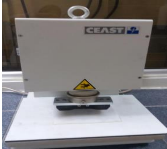
Figure IV.11 : Appareillage d'une poinçonneuse « Presse pneumatique à découper » [43]
