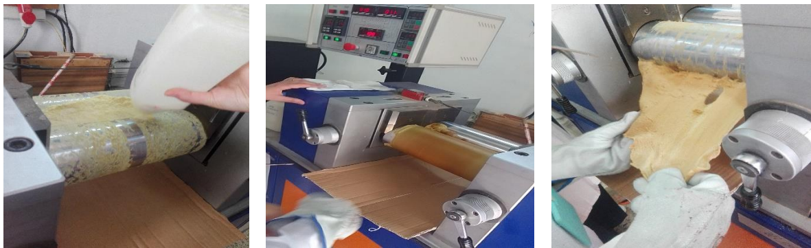
Figure IV.8 : L'opération de malaxage sur un mélangeur de deux cylindres
