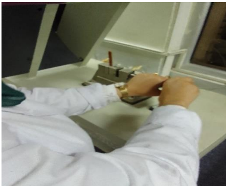
Figure IV.12 : Entailleuse pour entailler les échantillons pour le test IZOD
