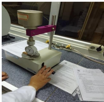
Figure IV.17 : Appareillage de mesure de la dureté Shore D
