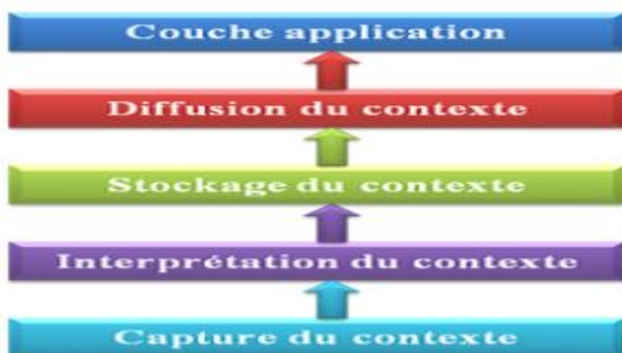
Figure 1.6: Structure générale d'un système sensible au contexte
