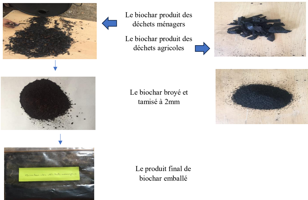
Figure. Biochar fabriqué à partir des déchets organiques ménagers organiques (Ordures de fruits et légumes) et agricoles (résidus de bois des branches et des écorces de chêne vert)
