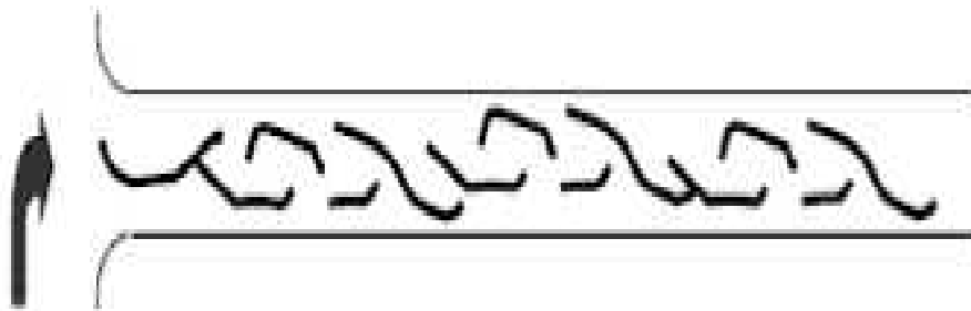
Figure II.7 : Ecoulement turbulent dans le conduit cylindrique [20].
