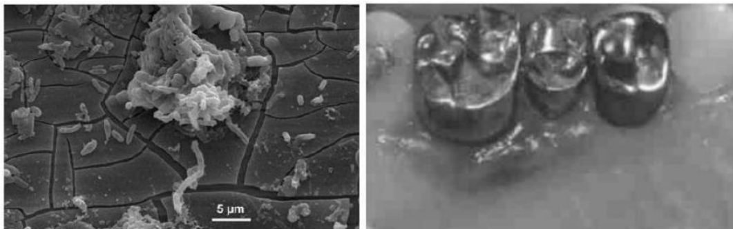
Figure I.9 : Exemple de bactéries responsable de la corrosion bactérienne et corrosion dentaire.
