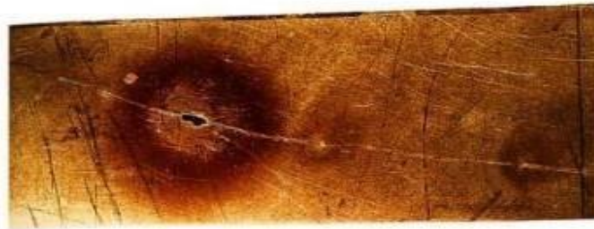
Figure I.4 : Corrosion par piqûres sur la paroi d'une cuve en acier Inoxydable austénitique Cr18-Ni10
