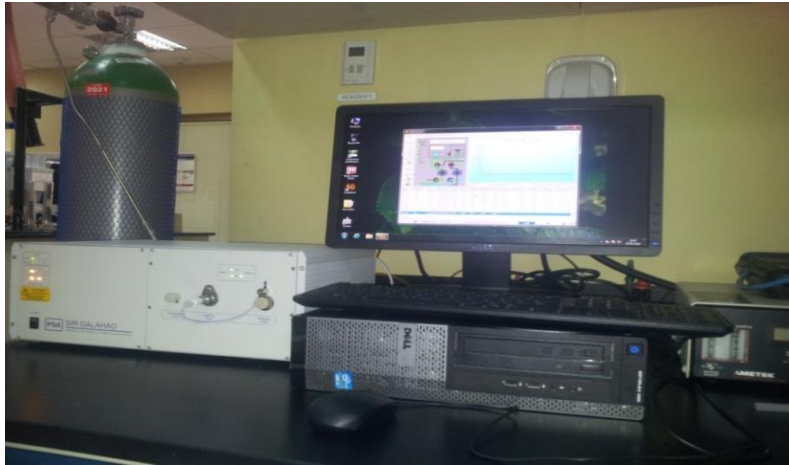
Figure III.33 : Appareil de mesure des vapeurs de mercure PSA 10.525 Sir Galahad.
