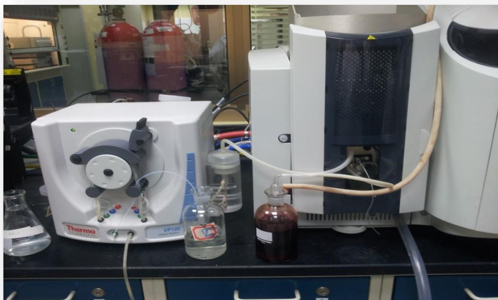
Figure III.30 : Spectromètre d'absorption atomique à générateur d'hydrure (VP thermo scientific).
