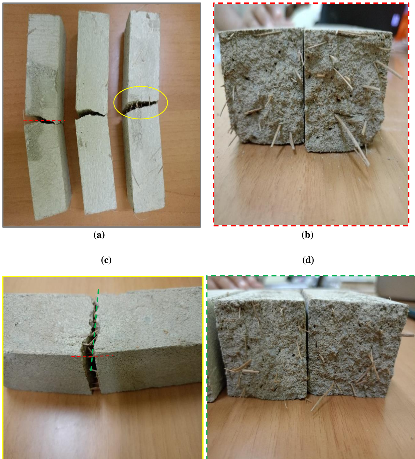
Figure III.5 : (a) Rupture en flexion des mortiers verts renforcés avec des fibres de W. robusta , (b) zoom de la section du mortier avec des fibres non traitées dans la zone rouge #3, (c) zoom du mortier avec des fibres traitées dans la zone jaune #16, et (d) zoom de la section du mortier dans la zone verte #16.
