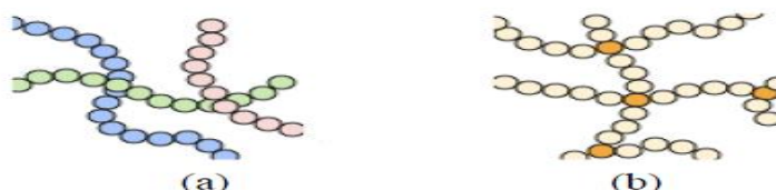
Figure I.3 : Structures moléculaires (a) d'un polymère thermoplastique, (b) d'un polymère thermodurcissable. [44].
